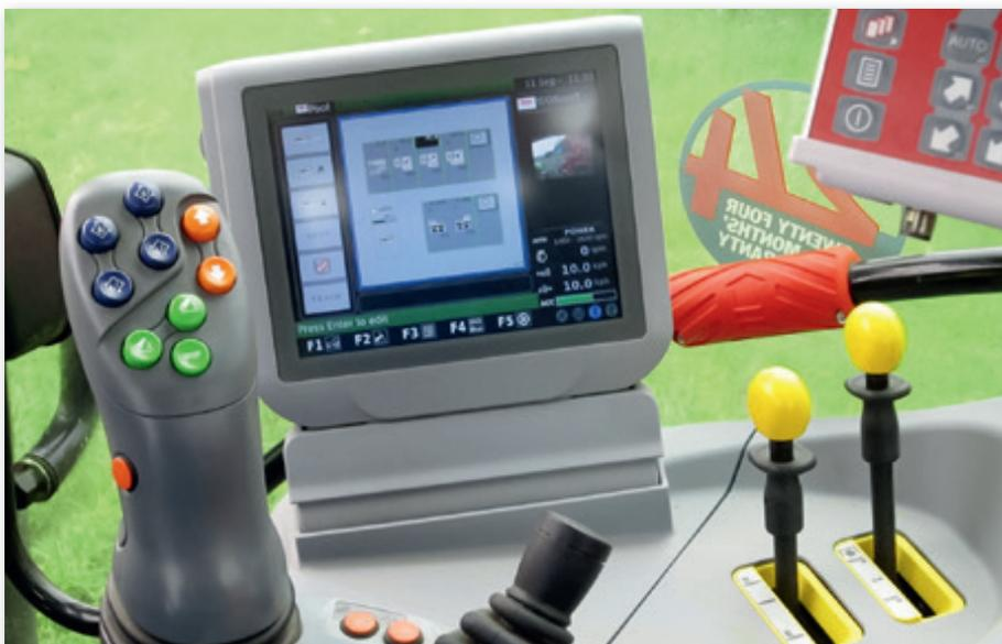
эргономичный перекидной переключатель с пленочными кнопками, джойстиком и поворотным потенциометром. Посредством данной системы можно запрограммировать до 77 разных задач.
